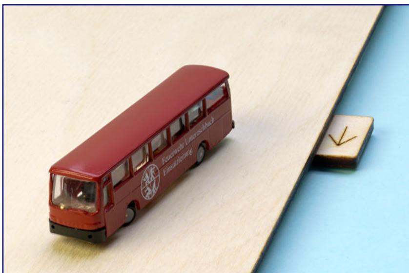
Mit einem Magnetfeld, das auf den Reed-Kontakt auf der rechten Fahrwerksseite des Busses wirkt, lässt sich der Bus unterwegs zum Stillstand bringen. Auf dem Testbrett wird dazu ein kleiner Permanentmagnet zwischen einer Stop- (Bild oben) und Fahrtstellung (Bild unten) verschoben.
