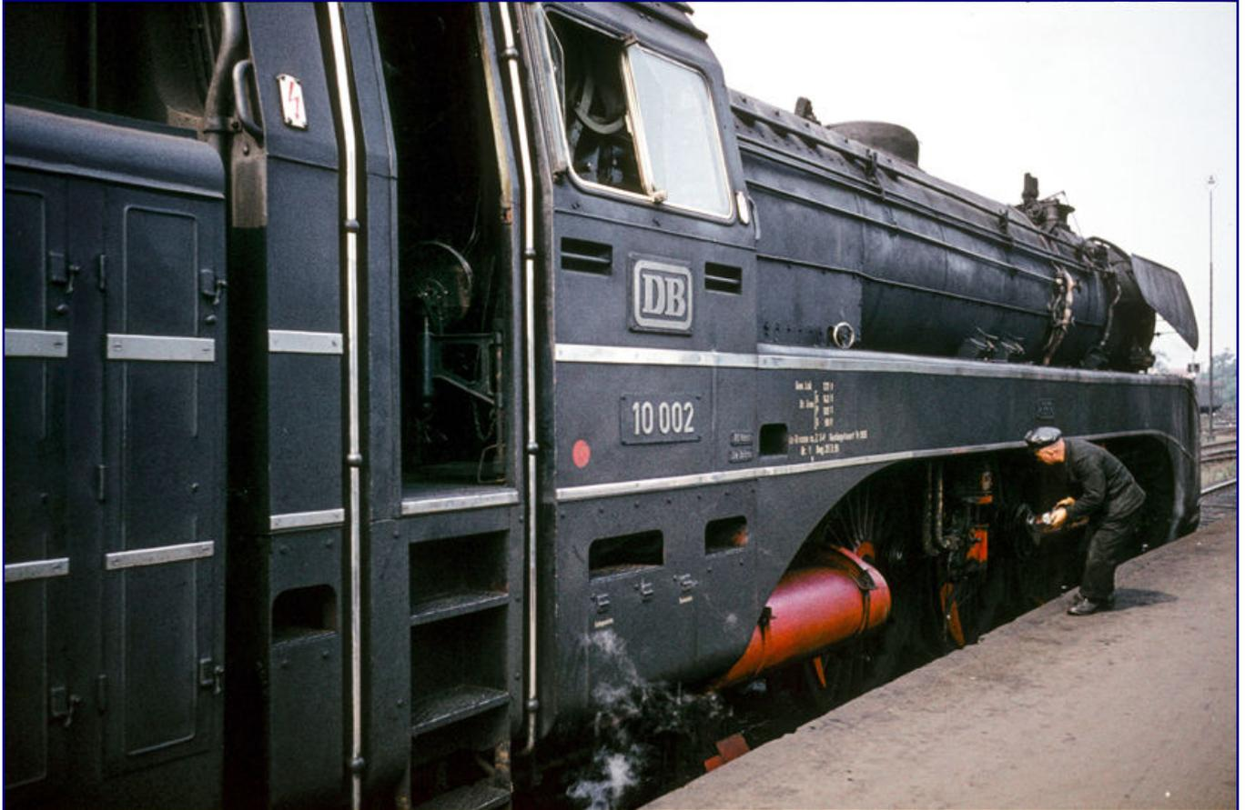
Beim Zwischenhalt in Hannover wirft der Lokführer von 10 002 des Bw Bebra einen prüfenden Blick aufs Triebwerk. Die offene Führerstandstür erlaubt einen Blick ins Innere mit dem in Fahrtrichtung zu bedienenden Reglerhebel. Foto:Archiv Petkelis (Fotograf unbekannt)
