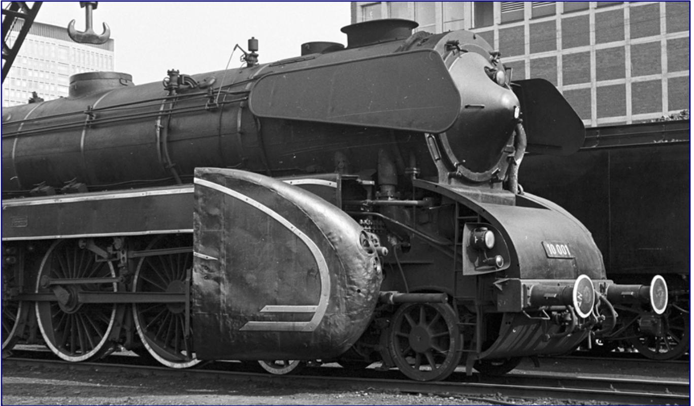
Die aufgeklappte Seitenschürze gibt den Blick auf einen Teil des vorderen Rahmens. Der darüber zu erkennende Innenzylinder bildet zusammen mit den Außenzylindern ein einheitliches Stahlgussstück, das mit dem Rahmen fest verschweißt ist (Mai 1967). Foto: Walter Patzke, Archiv Petkelis
