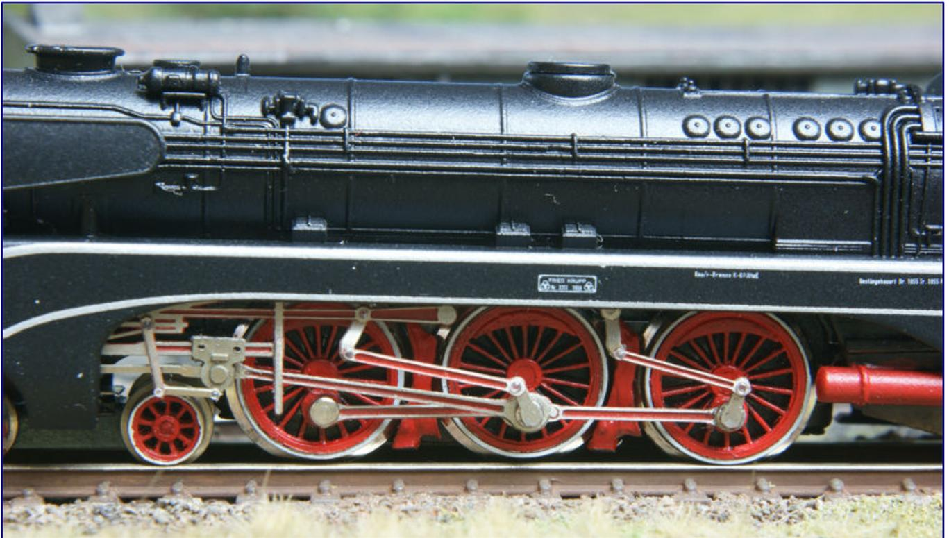
Der Blick aufs Detail zeigt die vollbewegliche Steuerung mit den zwei Schwingenstangen und Gegenkurbeln auf der Heizerseite sowie den feinsten Nieten, aber ebenso die elegante Wirkung der Weißwandreifen.
