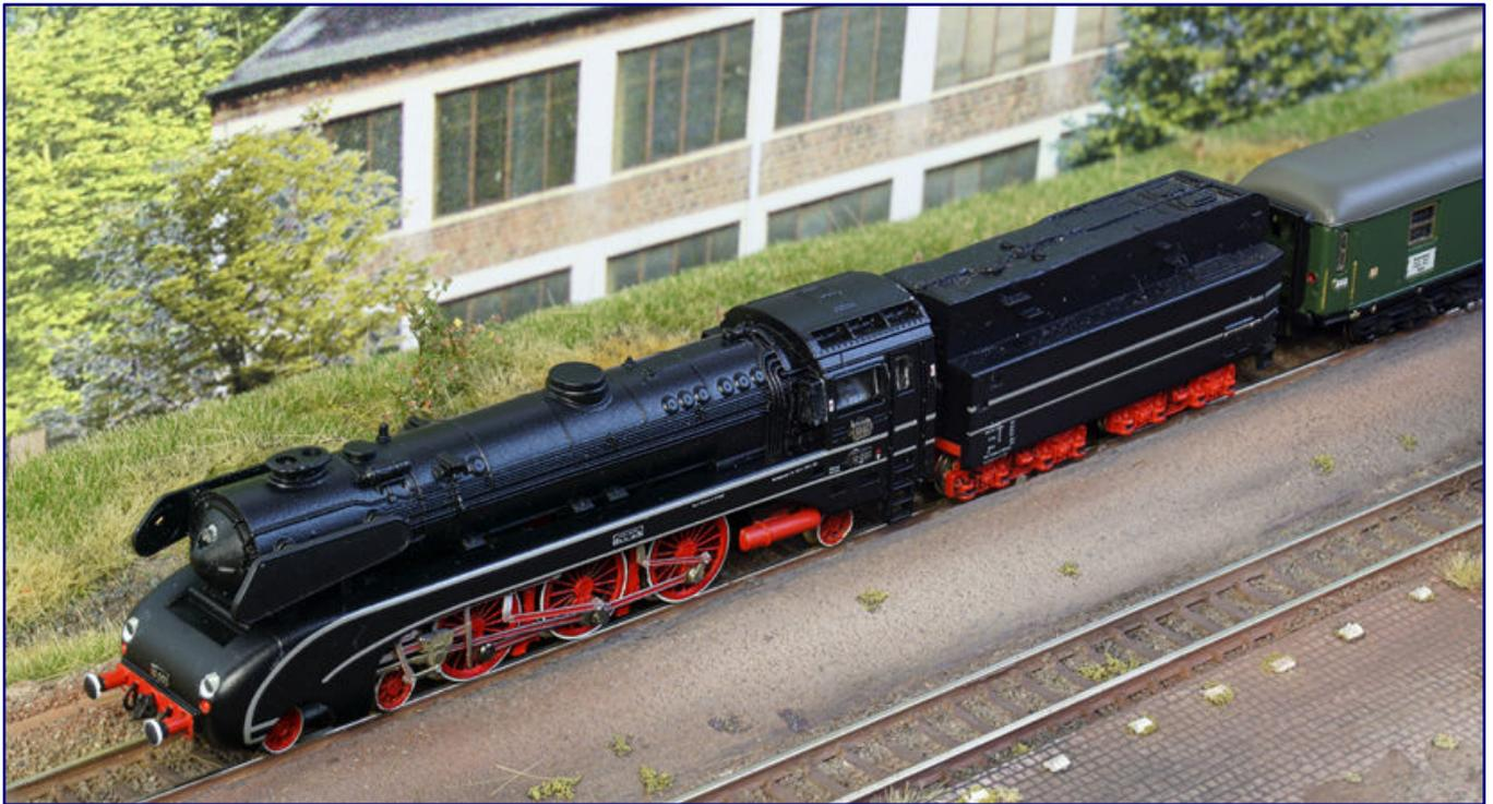
In Eigenarbeit erfolgte ein Umbau des Tenders vom abgedeckten Kohlenkasten auf einen großen Ölbehälter, an der Führerstandsstirnseite sind jetzt Windstauschuten angebracht. Insgesamt entspricht dieses Modell der 10 001 den späten Einsatzjahren beim Bw Kassel um 1967, als sie mit dem E 387/388 bis nach Münster (Westf.) und kurzzeitig sogar bis nach Rheine kam.
