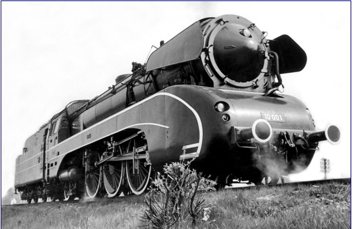
**Nach langen Überlegungen erhielt die beiden Maschinen der Baureihe 10 eine Stromlinienteilverkleidung in klassischer Lackierung. Für Eleganz sorgten aufgesetzte Zierlinien und die Witte-Windleitbleche in einer Sonderbauform. Die frisch abgelieferte 10 001 präsentiert sich ihrem Fotografen 1957 bei Minden in Ursprungsbauforn mit Dreiklangpfeife und Abdeckklappe auf dem Kohlenkasten des Tenders. Foto: Bustorff, Bildarchiv Eisenbahnstiftung**
