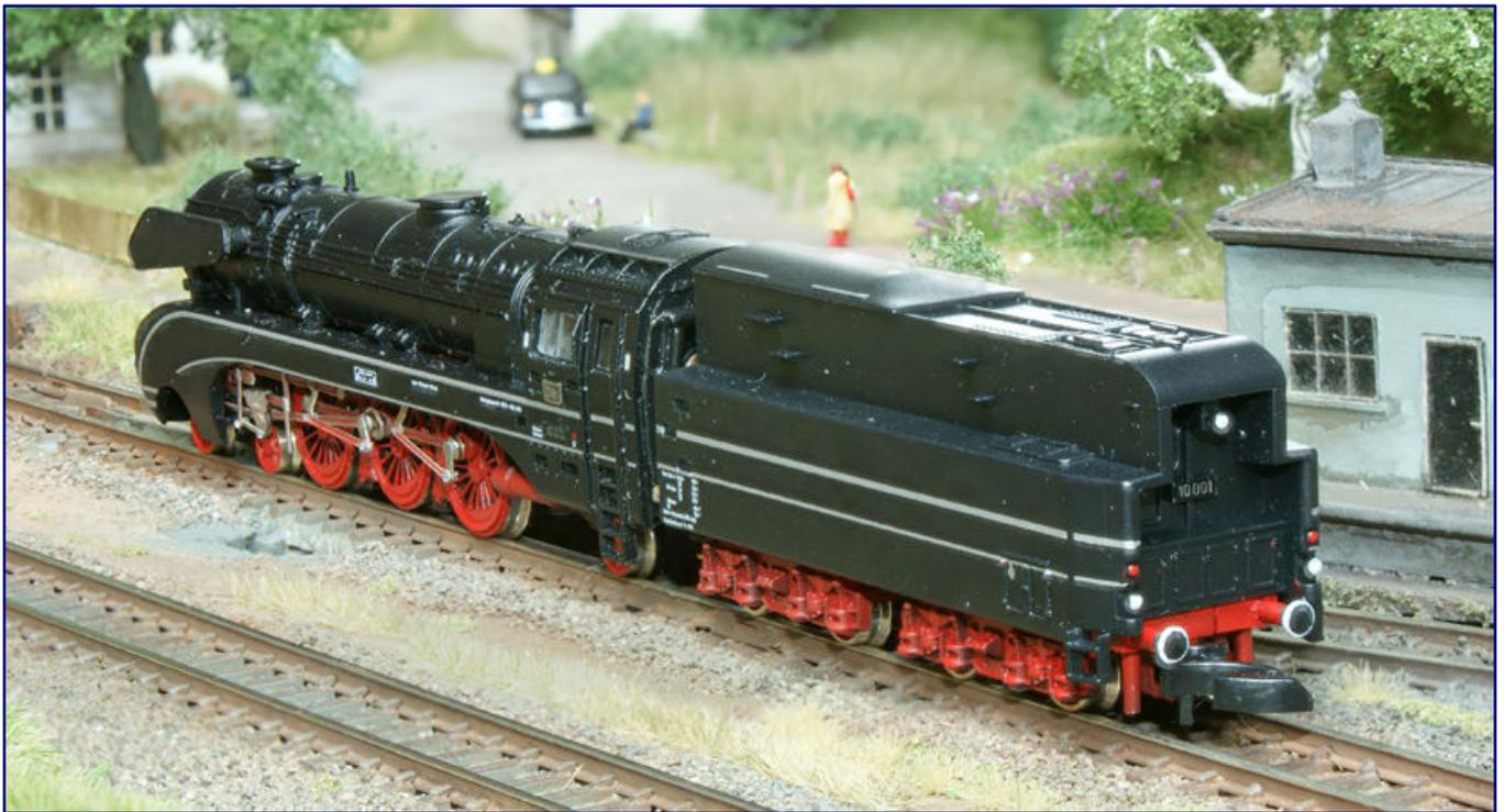
Der Tender kommt mit einigen farblichen Verbesserungen und getauschten Puffern aus. Seine Radreifen wurden im Gegensatz zur Lok aber nicht mitlackiert. Gut zu sehen ist auf diesem Bild hingegen, dass im Rahmen der Superung auch die Führerhausrückwand vorbildgerecht geschlossen wurde: Seitlich des Kohlenkastens ist ein Winkel des Gummiwulstes zu erkennen.
