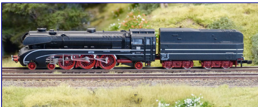
Michael Bahls hat erstmals, auf einem Märklin-Modell basierend, den „Schwarzen Schwan“ 10 001 mit vollbeweglicher Detailsteuerung und feinen, großenrichtigen Rädern ausgeliefert. Dem Spiel der Stangen zuzuschauen, ist ein besonderer Genuss, da die Lok auf der Heizerseite zwei Gegenkurbeln besitzt. Foto: Jörg Erkel
