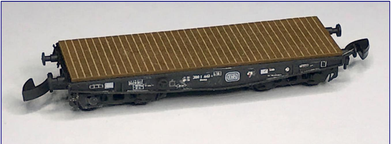
Bereits als Muster existiert die Ausführung des Schwerlastwagens SSkra Köln mit Trapezträgern, ursprünglich für den Panzertransport konstruiert. Zu sehen sind die Versionen als SSy 45 für den Rungeneinsatz und mit Ladeschwellen der DR (Bild oben) und als Rlmp 700 ohne Ladeschwellen der DB (Bild unten). Foto: eNKay-Design
