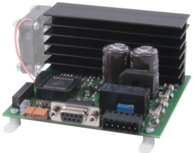
Der analoge Fahrregler SFR2000 erhält ein neues, kompaktes Bedienteil (oben). Das mit ihm verbundene Leistungsteil erlaubt in der offenen Ausführung (unten) einen Blick auf seine „Innereien“. Foto (Mitte links und unten rechts): Heißwolf Modellbahnzubehör
