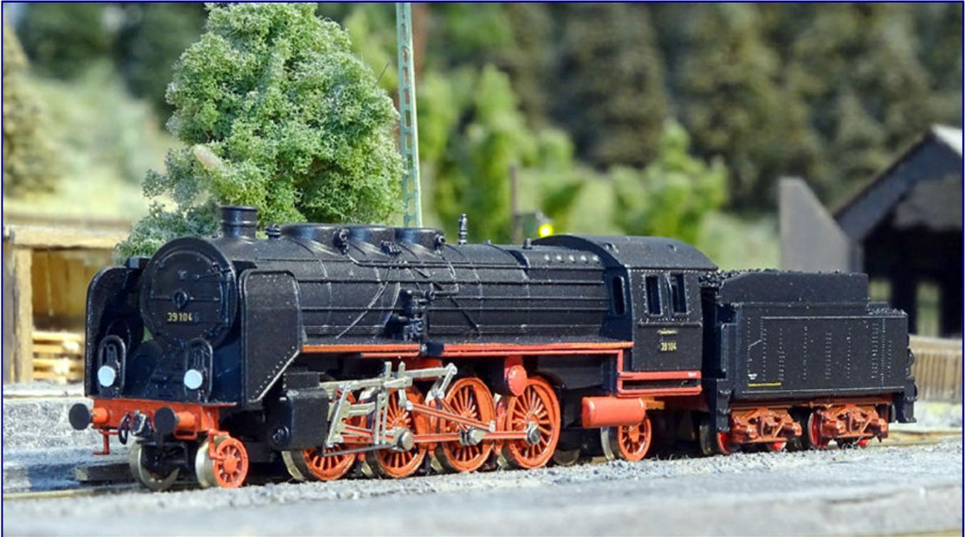
Mit neuen Kuppel- und Treibrädern in richtiger Größe, einer vorbildgerecht neu gestalteten Schürze und Pufferbohle, freistehenden Laternen sowie vollbeweglicher Detailsteuerung holt Bahls Modelleisenbahnen aus Märklins Baureihe 39 alles heraus, was möglich ist. Foto: Jens Wimmel (ZettZeit)
