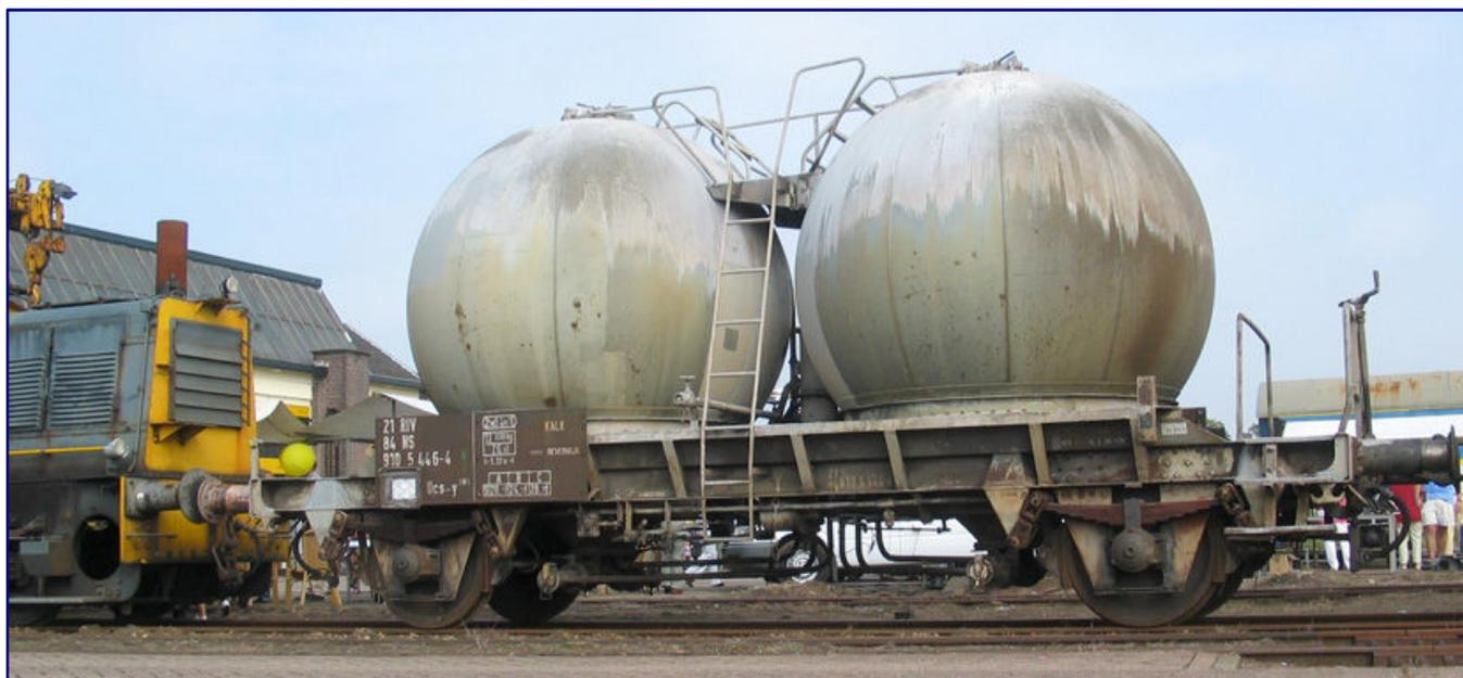
In den fünfziger Jahren begann die Entwicklung der modernen Staubgutwagen. Die Niederländische Staatsbahn beschaffte sie mit Kugelbehältern in drei verschiedenen Größen. Auf dem Bild zu sehen ist ein Wagen der Bauart Ucs-y 381 mit 14 m<sup>3</sup> fassenden Kugeln. Gekuppelt ist dieser Bollenwagen mit einer Rangierlok Sik, die es als Modell bei Z-Modellbau zu kaufen gibt. Foto: Nico Spilt
