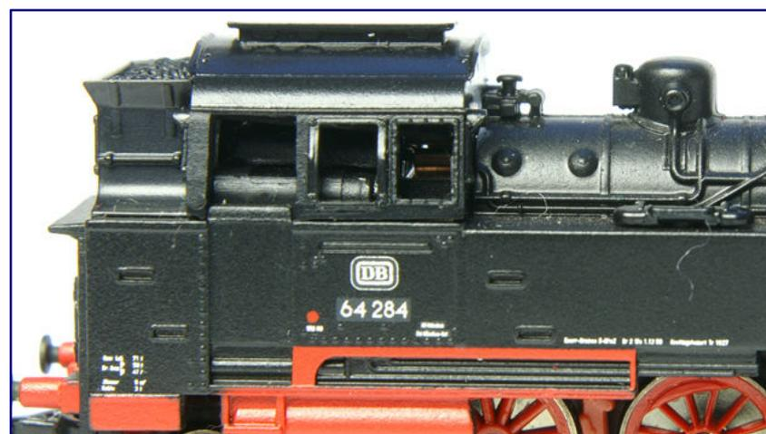
Die Staubfluse am Wasserkasten offenbart die starke Vergrößerung dieser Aufnahme: Zu sehen ist die gelungene und lupenreine Beschriftung, aber auch die Kante des aufgesetzten Führerhausoberteils. Zu den Ansetzteilen aus Kunststoff gehört auch der Wasserkastendeckel.
