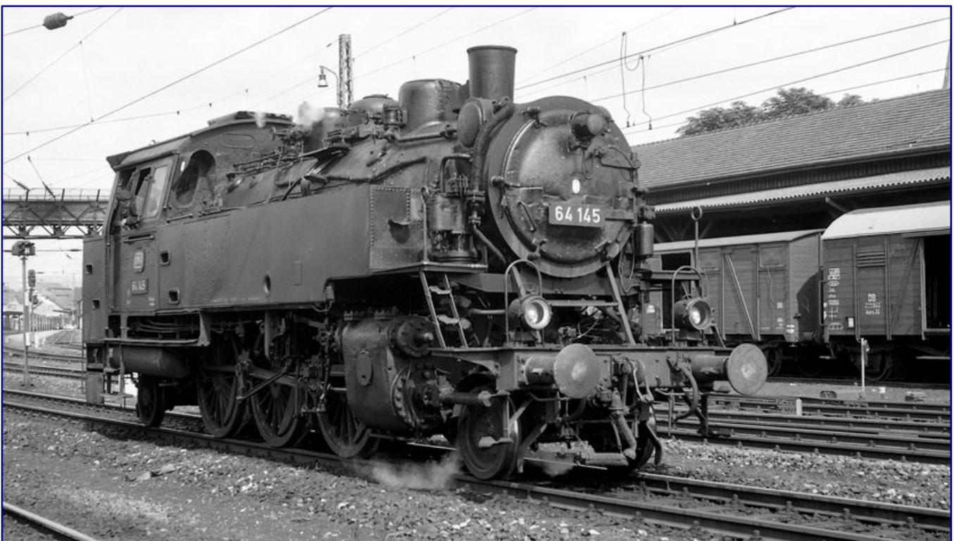
Spielarten der Baureihe 64 bei der DB: 64 147 lässt im Bw Nürnberg erkennen, dass sie an der Lokführerseite ein Schild mit spitzen Ziffern trägt, während auf der Rauchkammer die DIN-Schrift der Bundesbahn zu erkennen ist (Bild oben; Foto: Walter Patzke, Archiv Petkelis). 64 145 präsentiert sich 1966 mit Scheibenvorlauferrädern im Bahnhof Schorndorf (Bild unten; Foto: Burkhard Wollny, Archiv Eisenbahnstiftung). Auf den Pufferbohlen beider Maschinen sitzen die alten Reichsbahnlaternen.
