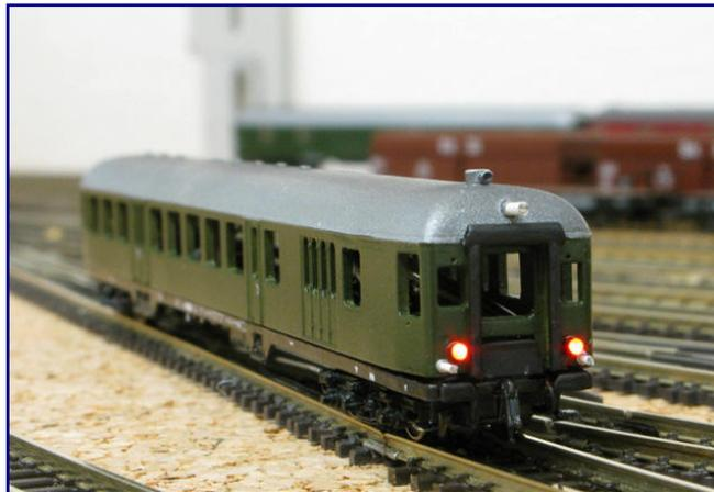
Lichtprobe: Dank einer mit Goldcap-Kondensator bestückten Platine im Inneren erhielt das Modell auch eine flackerfreie Beleuchtung. Fahrtrichtungsabhängig leuchtet entweder ein weißes Dreilicht-Spitzensignal oder rotes Schlusslicht. Fotos: Dirk Rohwerder
