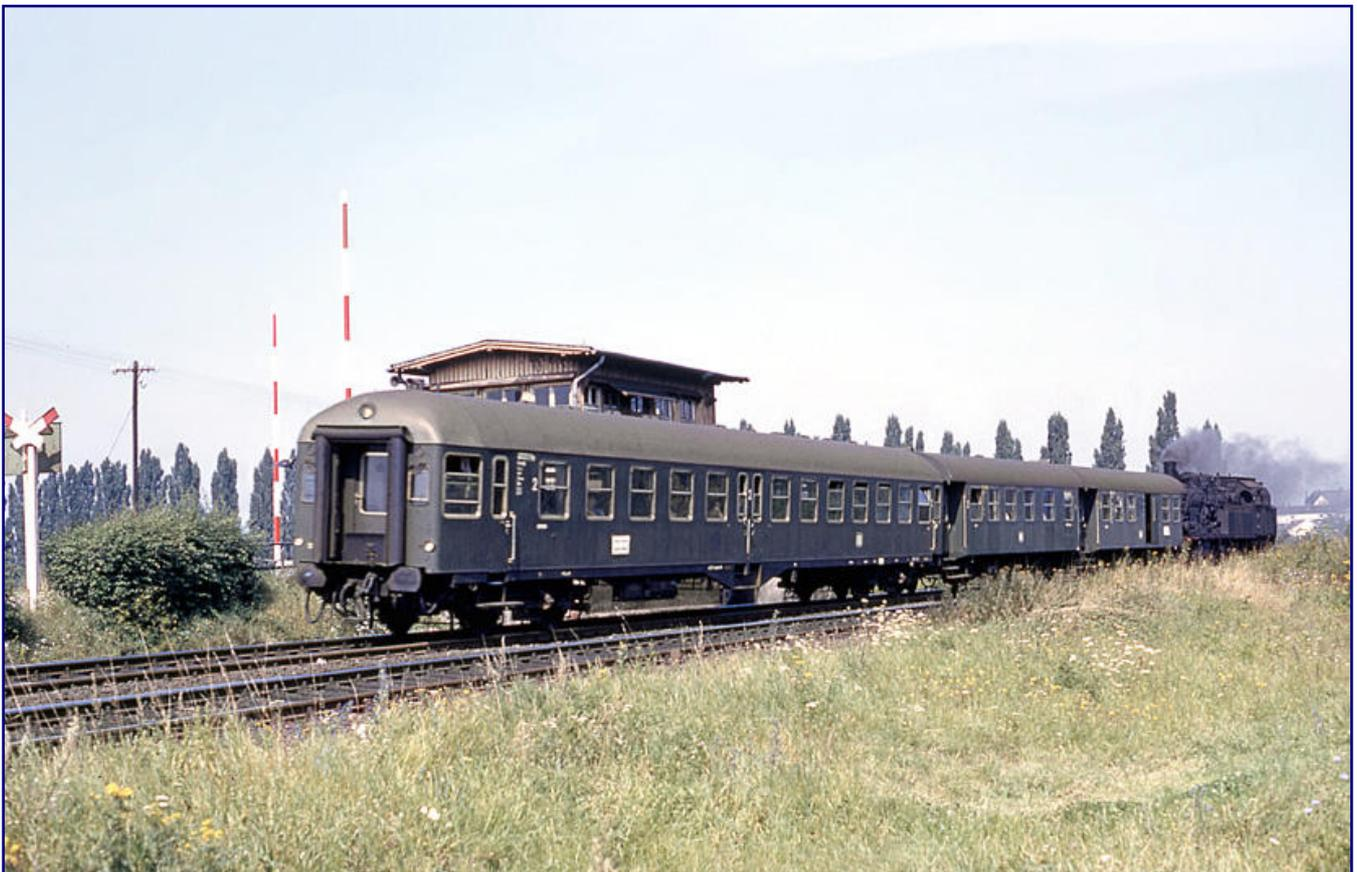
Schon zur zweiten Generation der Wendezüge gehörten die kombinierten Befehls- und Steuerwagen der Mitteleinstiegswagen, hier am 18. August 1958 als B4ylf voraus fahrend. Zwischen ihm und der indirekt gesteuerten 78 409 laufen zwei zu Leitungswagen umgebaute Umbauwagen. Bemerkenswert an der Aufnahme, die am Abzweig Niddabrücke bei Frankfurt-Rödelheim entstand, ist auch die damals noch übliche Form des Andreaskreuzes am linken Bildrand. Foto: Brian Bittner, Sammlung Eisenbahnstiftung
