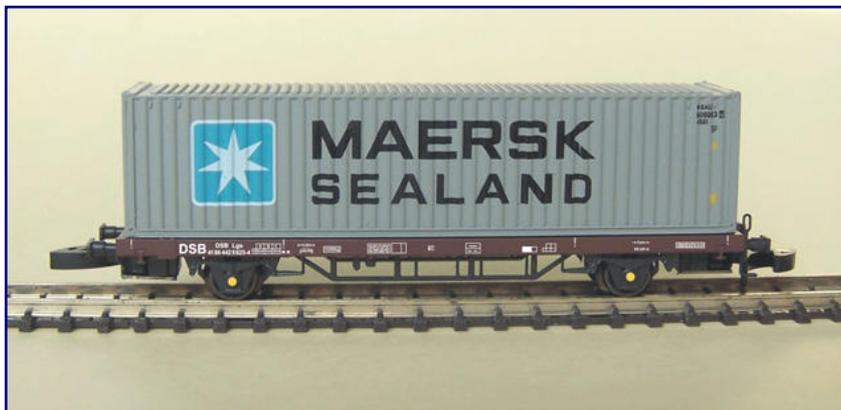
Der gedeckte Güterwagen Bauart Gbls der SJ (Bild oben) und der bei der DSB eingestellte Tragwagen Lgs mit Hi-Cube-Container (Bild unten) sind weitere Skandinavien-Neuheiten bei FR. Foto: FR Freudenreich Feinwerktechnik
