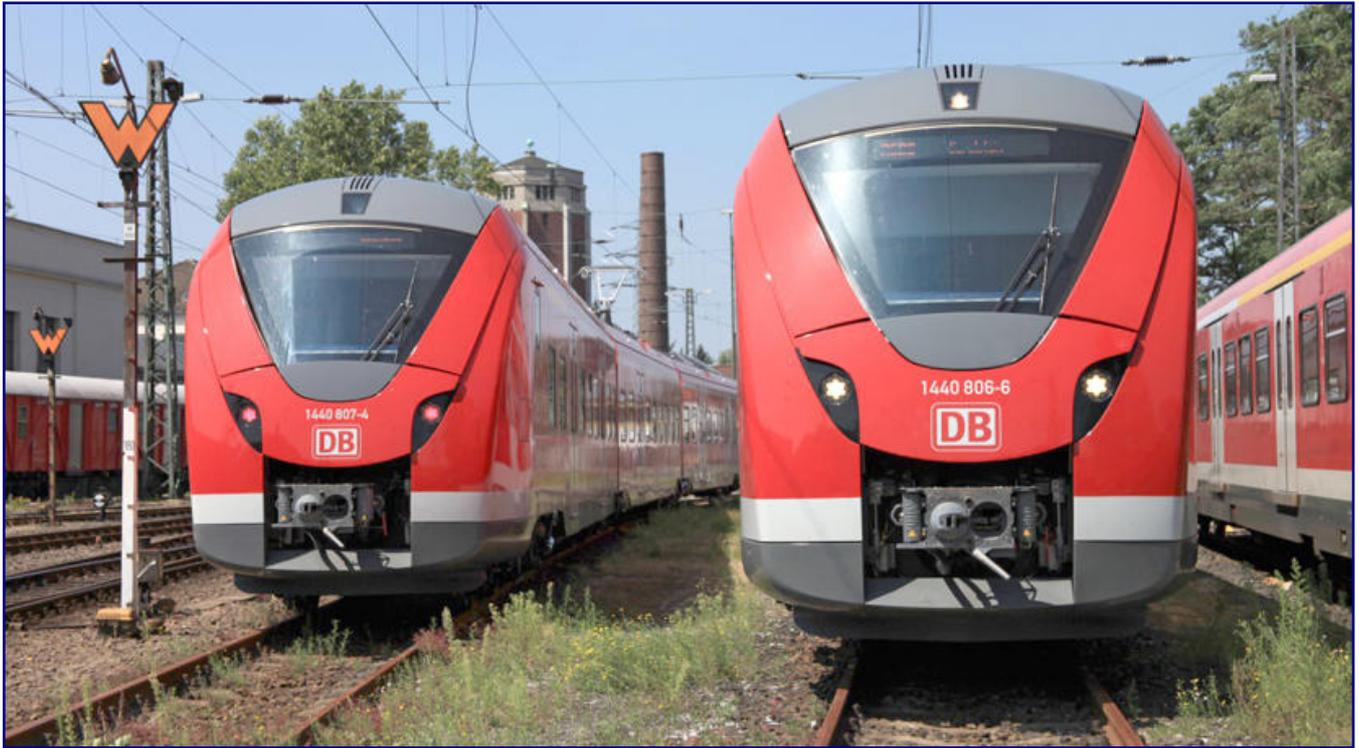
Zur gestiegenen Attraktivität des Schienenpersonennahverkehrs tragen in erheblichem Maße neue Fahrzeuge bei: Von der Baureihe 1440 (Alstom Coradia Continental) hat DB Regio 28 Triebzüge für die Linien S5 und S6 der S-Bahn Rhein-Ruhr bestellt. Die ersten Exemplare der elektrischen Triebzüge mit modifiziertem Kopf nach Norm EN 15227 und einem freundlich lächelndem Gesicht befinden sich derzeit in der Testphase durch das Werk Düsseldorf. Foto: Deutsche Bahn AG/Bernd Piplack
