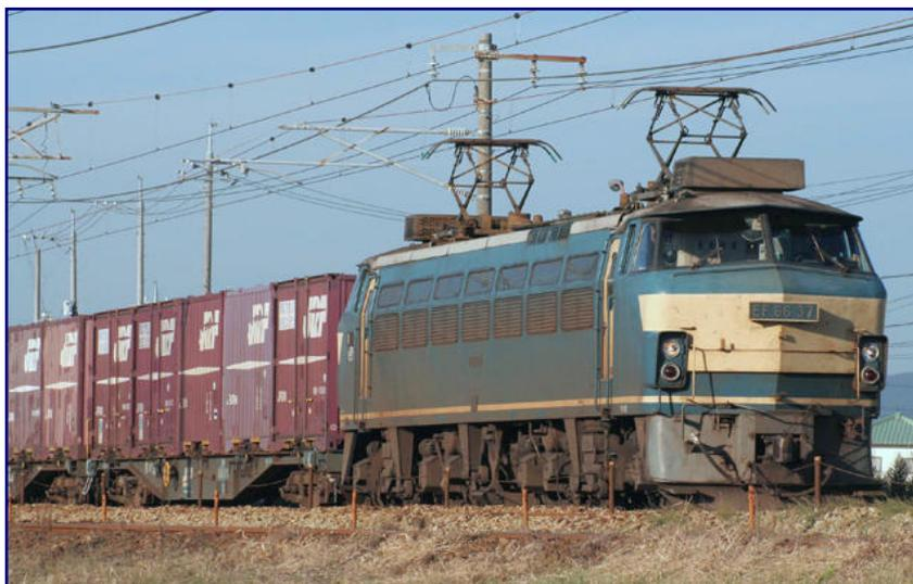
Die EF66 37 aus der ersten Serie entspricht mit dem verlängerten Führerhausdach und Klimaanlageaufbauten dem Modell der modernisierten Ausführung von Rokuhan (17. Oktober 2007). Foto: Mitsuki-2368 (GFDL-1.2)
