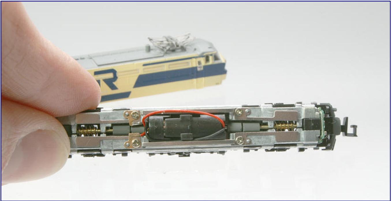
Das Fahrwerk besteht aus zwei Gusshälften, die in Längsrichtung geteilt sind. Der Antrieb von vier Achsen erfolgt mittels Schneckengetriebe durch einen bürstenlosen Motor.
