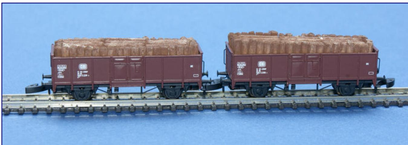
Nach der Fixierung ist der Pulverfarbenauftrag griffest. Und das Ergebnis kommt dem Aussehen des Vorbilds überraschend nahe! Wenn ein Einsatz noch nicht perfekt passt (im Bild rechts), sind die betroffenen Stellen zu lokalisieren und mit der Feile nachzuarbeiten.
