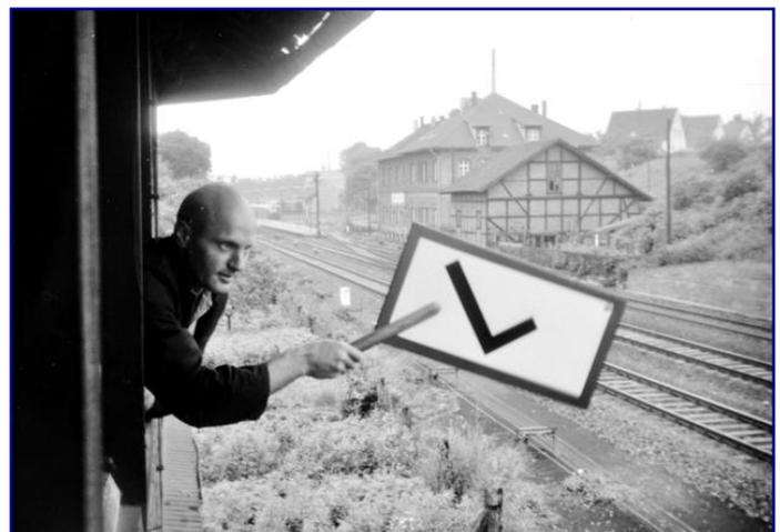
Die Eisenbahnstiftung ist eine wichtige Bildquelle für uns: Durch das Signal Zs 5 „Verzögerungsanzeiger“ wurde ein Zug beauftragt, vom Erkennen des Signals bis zur nächsten Zugfolgestelle, seine Fahrgeschwindigkeit um 1/3 zu reduzieren. Foto (1966): Johannes Glöckner, Sammlung Eisenbahnstiftung
