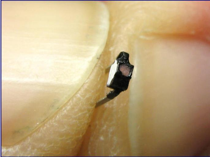
Die Drahtenden wurden so nah wie möglich an den LED-Körper gebogen. In der Stirnansicht sollte durch die Drähte der Eindruck des Laternenhalters unterhalb und des Lüfters oberhalb der Laterne entstehen.
