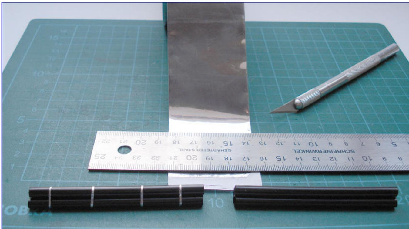
Das Klebeband ist dünn wie Alufolie, entsprechend vorsichtig ist es zu schneiden. Für etwas Erleichterung sorgt dabei die Trägerfolie. Anschließend sind mit den 1 mm dünnen Blechstreifen die Röhren zu belegen, um Spannbänder nachzubilden.
