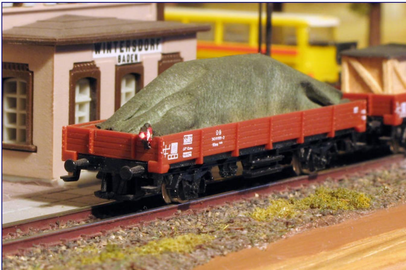
Beim Niederbordwagen ist Tarnung angesagt, um die elektronischen Bauteile vor dem Auge zu verstecken. Daher wurden sie frei auf der Ladefläche platziert und anschließend mit einer Plane, die aus Taschentuch entstanden ist (siehe auch Baubericht weiter vorn), verdeckt.
