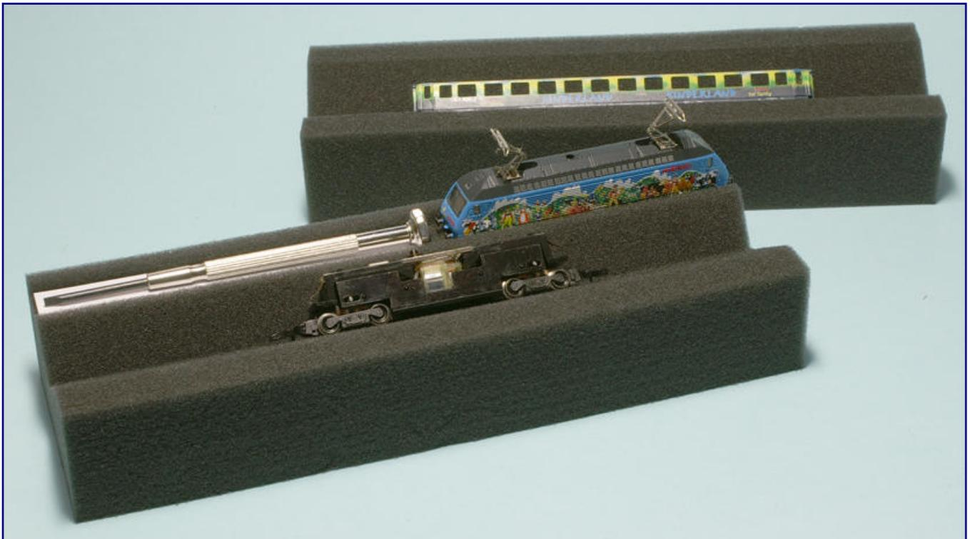
Die Lokliegen von Volker Wienke eignen sich ideal zur Wartung und Reparatur von Modellen. Werkzeuge und Metallteile werden vom Magnetstreifen (unteres Modell) gehalten. Auch das Beschriften von Modellen ist in der flachen Liegeposition möglich.
