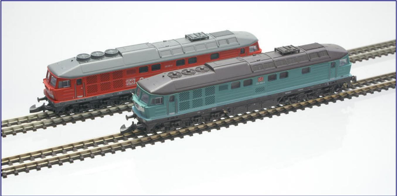
Die direkte Gegenüberstellung beider Modelle verdeutlicht die Formänderungen, die Märklin vorgenommen hat: Die verkehrsrote Maschine aus der Kalkzugpackung (81450; hinten) trägt am hinteren Fahrzeugende (im Bild links) höhere Dachlüfter als das mintgrüne Einzelmodell (88131; vorne). Bei beiden ist der Dachaufbau vollständig und sehr detailliert wiedergegeben worden.
