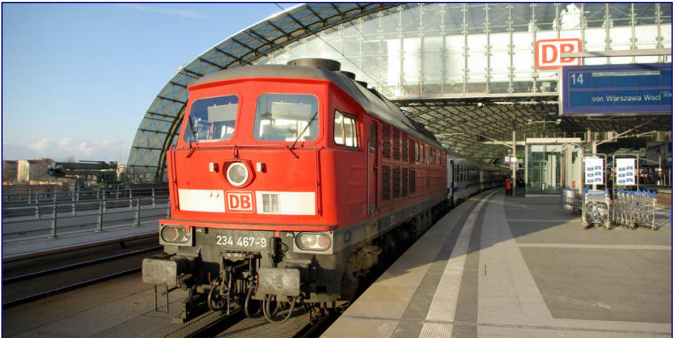
Für den Einsatz im hochwertigen Reisezugverkehr ließ die DR 1991 insgesamt 35 Maschinen zur Baureihe 234 umbauen, die für 140 km/h Höchstgeschwindigkeit zugelassen waren. Sie kamen auch bei der DB AG noch zu Fernverkehrseinsätzen: 234 467-9 ist am 26. März 2008 soeben mit einem Eurocity aus Warschau in Berlin Hbf angekommen. Foto: Johannes Fielitz (GNU)
