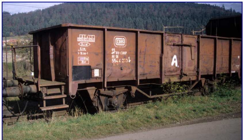
Seine besten Zeiten hat dieser E 050 hinter sich. Die gestrichene Zahlenkombination 01 für das RIV-EUROP-Austauschverfahren zeigt, dass er nur noch national einsetzbar war. Foto: Eckerle, Archiv Petkelis
