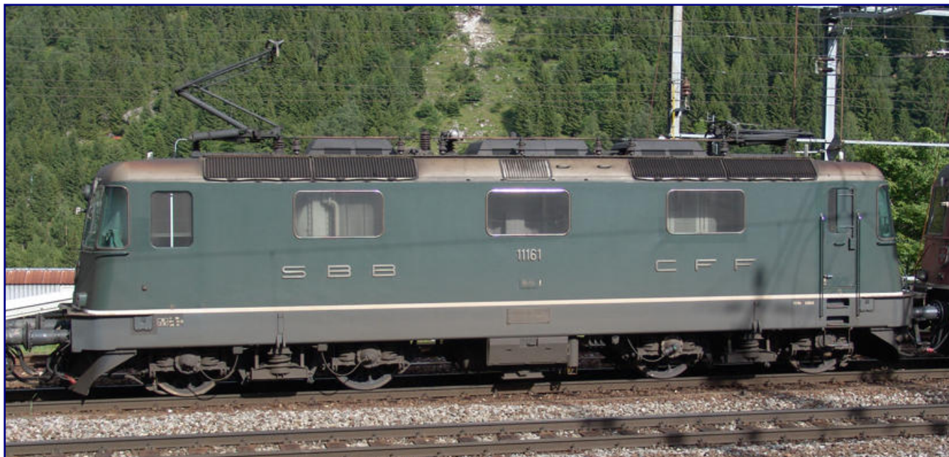
Das Vorbild im grünen Lack in der Seitenansicht: Wie Märklins Modell 88590 ist es mit eckigen Lampen und Einholmpantographen ausgestattet. Diese Aufnahme bietet sich geradezu für einen Vergleich mit der Miniatur an. Foto: Jens Wimmel
