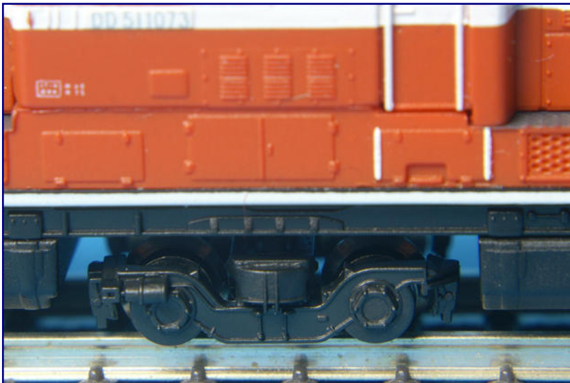
Ein Blick auf die Drehgestelle der DD51: Außen sitzen Triebdrehgestelle mit je vier Sandkästen (Bild oben), das Laufdrehgestell in der Fahrzeugmitte (Bild unten) zeichnet sich durch sehr kleine Räder mit nur 3,0 mm Durchmesser aus.
