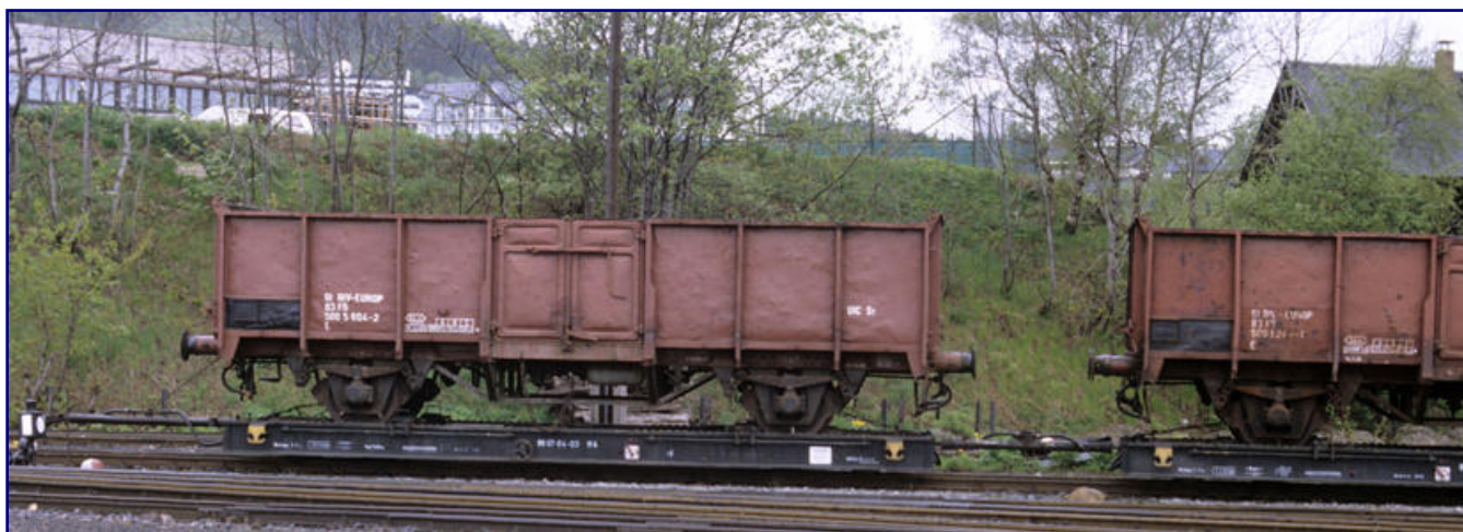
Als UIC-Standardbauart waren die in Deutschland als E 040 bezeichneten Wagen in gleicher Form auch bei anderen Bahnverwaltungen Europas zu finden. Dieser auf einem schmalspurigen Rollwagen verladene Waggon gehört wie sein rechter Nachbar der italienischen Staatsbahn FS. Foto: Eckerle, Archiv Petkelis
