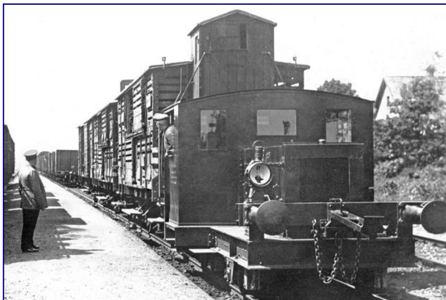
Eine Windhoff-Kleinlok mit 25 PS Leistung setzt im Jahr 1931 Viehwagen der Verbandsbauart im Bahnhof Fürstenu (Strecke Rheine – Quakenbrück) an den auf Gleis 2 wartenden Güterzug. Foto: RVM, Slg. Eisenbahnstiftung
