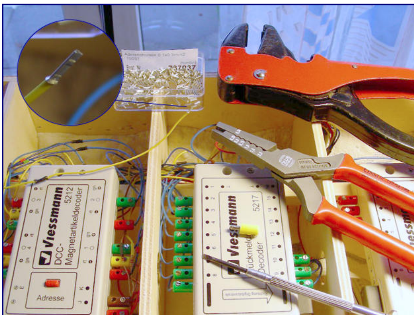
Nur Aderhülsen (siehe Ausschnittsvergrößerung) verhindern ein Abquetschen der Litzenenden in den Märklin-Steckern.
