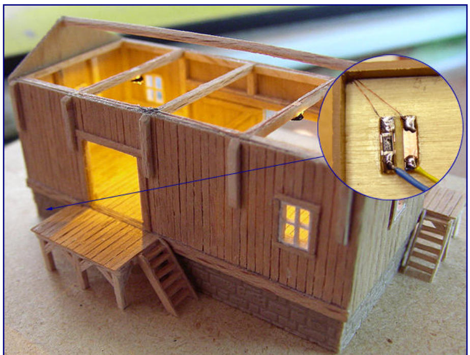
Die Kupferlackdrähte zu den LED der Innenleuchten werden über die Oberkante der Wände (von im Bild) und die Querbalken, an denen die Leuchten hängen, geführt. In einer Gebäudeecke führen die Drähte nach unten zur Anschlussplatine (siehe Bildausschnitt), die unter dem Sockel sitzt und auch den Vorwiderstand enthält. Mittlerweile fertig sind auch die Laderampen und Treppen des Schuppens.
