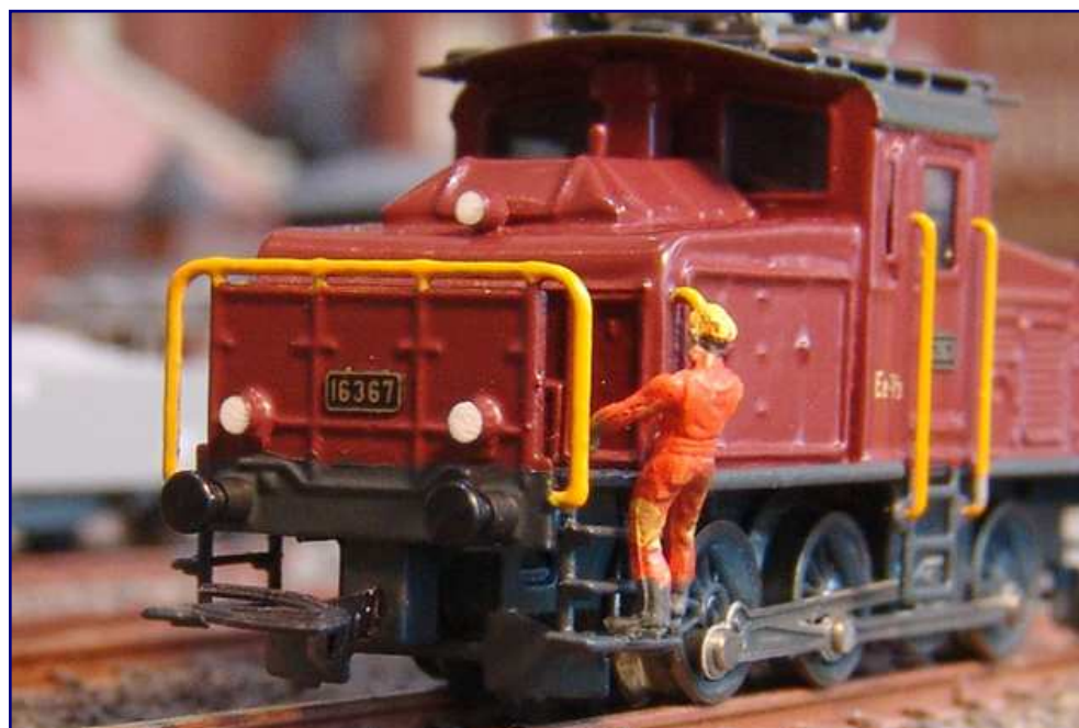
Wiedergegeben wurden auch die Schienenräumer, die Aufstiege sowie die erhabenen Gegengewichte der Ee 3/3. So muss sich das Modell von keiner Seite verstecken!
