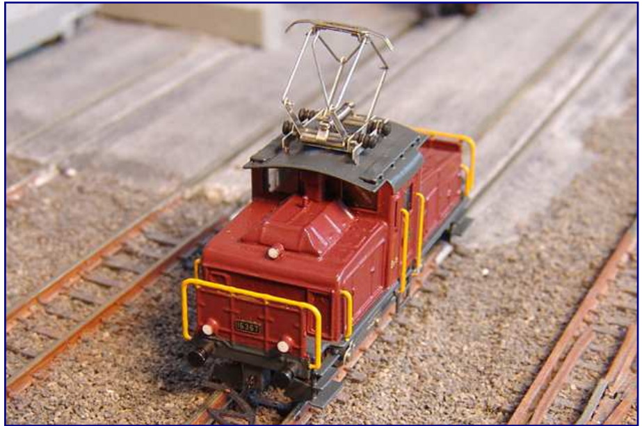
Auch der BBC-Stromabnehmer mit der schmalen Wippe und quer liegenden Isolatoren ist eine Neukonstruktion von Z-Modellbau. Die Ee 3/3 besitzt wie das Vorbild keine weitere Dachausrüstung.
