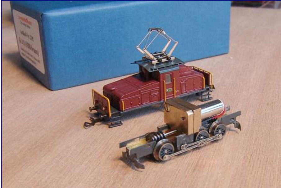
Bewährtes Konzept: Verschiedene Getriebestufen reduzieren die Drehzahl des kleinen Motors und schöpfen Kraft.
