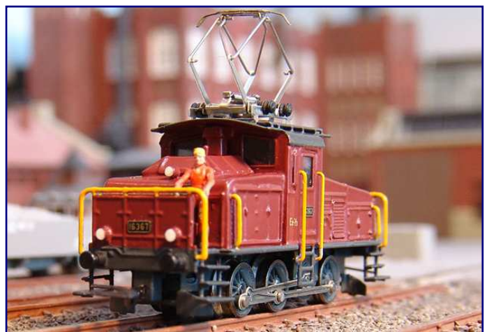
Vor dem Trainini-Testzyklus wird die Lok zunächst je Fahrtrichtung zwei Stunden lang gründlich eingefahren.
