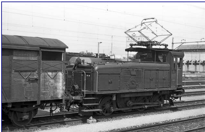
Die Ee 3/3 16325 ist die vorletzte Lok der ersten Serie. Wegen ihres Endführerstands und des langen Vorbaus erinnerte sie in ihrem Erscheinungsbild an ein Bügeleisen. Deshalb erhielt diese Bauart den Spitznamen „Glätteisen“. Foto: Walter Patzke, Sammlung Petkelis
