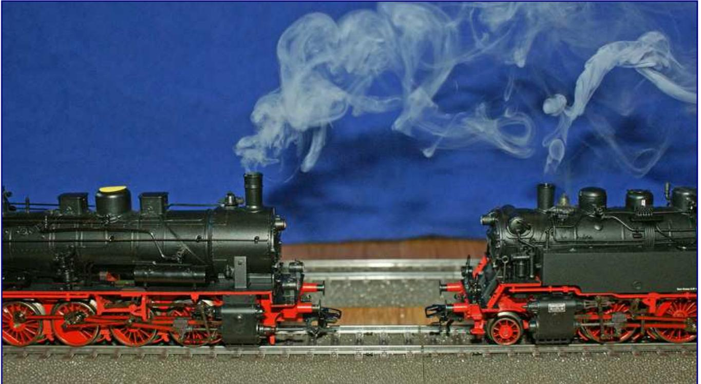
Aussagen zur Intensität des Dampfausstoßes lassen sich am besten im direkten Vergleich gewinnen. Dafür ist es aber wichtig, das Arbeitsprinzip des Generators zu kennen und identische Exemplare einzusetzen: Deutlich zeigt sich nun, dass das Produkt von Seuthe (links, gelbe Dommarkierung) eine dichtere Dampf Wolke erzeugt als Viessmann Konkurrenzprodukt (rechts).
