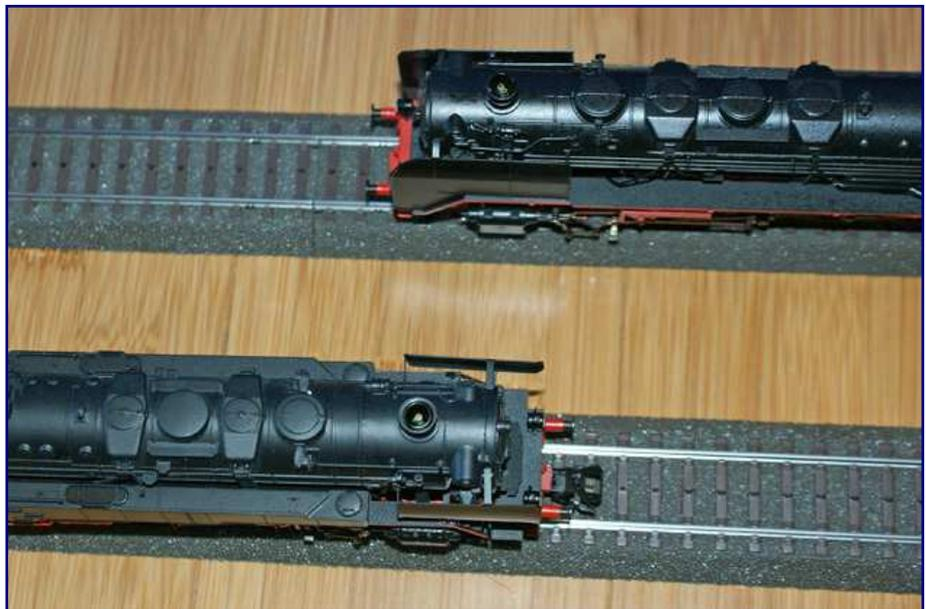
Einige Produkte hinterlassen Niederschläge auf dem Kessel, wie oben an der Baureihe 44 als glänzende Stellen zu sehen. Vorbildlich ist an dieser Stelle das neue Produkt von Viessmann, das im normalen Anlagenbetrieb keinerlei Spuren hinterlässt. An dieser Stelle hat der Hersteller den Mund also nicht zu voll genommen!
