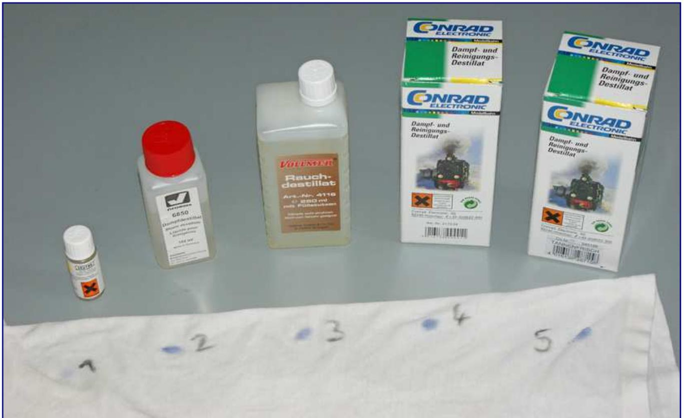
Mit Abstand am geringsten ist der Abrieb von Lack und Beschriftung beim Destillat von Seithe. Das erfreut besonders unter dem Gesichtspunkt der stärksten Niederschläge bei diesem Produkt: Das Modell ist nicht in Gefahr. Die übrigen vier Kandidaten liegen im Ergebnis recht nah beieinander.
