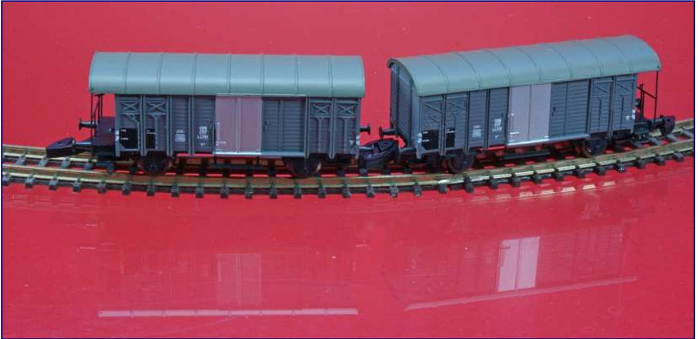
Wie die Hauptneuheit des Vorjahres auch entstand auch der K3 wieder in einer Mischbauweise: Das Gehäuse aus Kunststoff-Spritzguss ruht auf einem Metallfahrwerk, welches den Wagen sicher im Gleis führt und ihm das für seine Betriebssicherheit erforderliche Gewicht verleiht.
