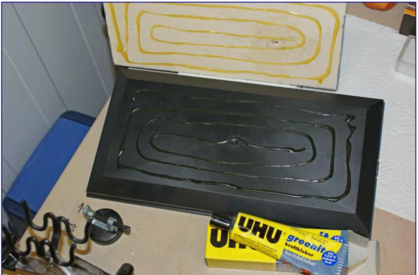
Wenn die groben Arbeiten an der Bodenplatte beendet sind und alle wichtigen Komponenten eingepasst wurden, darf sie auf dem Sockel der Conrad-Klarsichtbox aufgeklebt werden. Ein geeigneter Klebstoff dafür ist Uhu greenit, denn das Kontaktklebeverfahren verspricht dauerhaft den besteh Halt.
