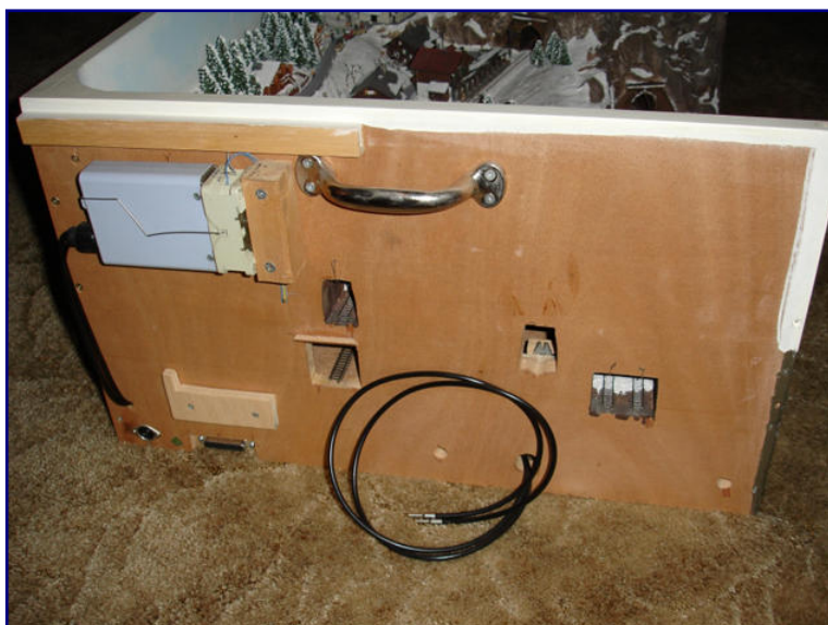
Bild links: Die elektrischen sowie Schienen- und Modulverbindungen als Gegenstück zur oben gezeigten Modulinnenseite des linken Endmoduls.
