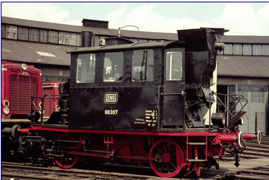
Seitliche Rückansicht des „Spalter Bockerl“ im Bw Nürnberg Hbf: Das Umlaufgeländer und die Führerstandstüren sind geöffnet. Die Lok trägt, wie teilweise auch zu ihrer aktiven Dienstzeit, einen Puffertellerwarnanstrich. Foto: Rolf Hahmann
