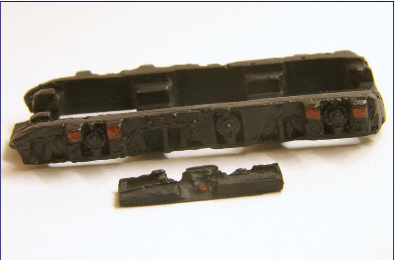
Der gesamte Umrüstsatz von MWB für Märklins E 50 besteht aus insgesamt vier Teilen (Bild oben). Für die Mittelteile (Attrappen der Drehgestellüberstände und Indusi-Magnete) sind einige Feilarbeiten am Fahrwerk erforderlich, während die Original-Drehgestellrahmen einfach nur ausgetauscht werden. Die Makroaufnahme zeigt die feinen und stimmigen Details wie auch den asymmetrischen Achsstand.
