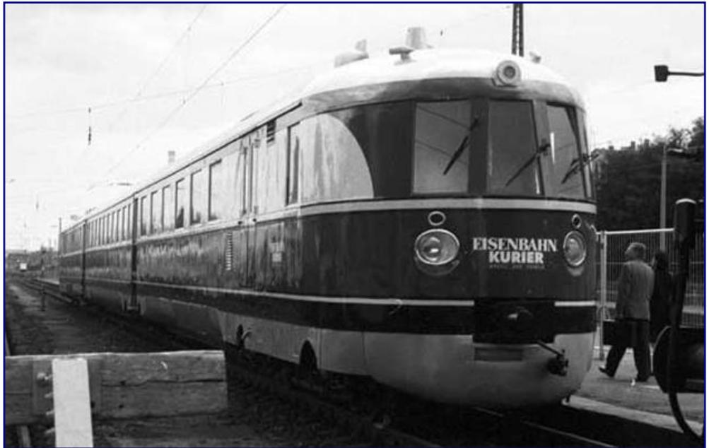
Als einzige aller Schnelltriebwagen bot die dreiteilige Bauart Leipzig ab 1935/36 auch Sitzplätze in der 3. Klasse an. Einer dieser Züge stellte mit 205 km/h den damaligen Geschwindigkeitsrekord für Serienschienenfahrzeuge auf. Der Eisenbahn-Kurier erhält einen solchen Zug museal. Foto: Walter Patzke, Sammlung Petkelis
