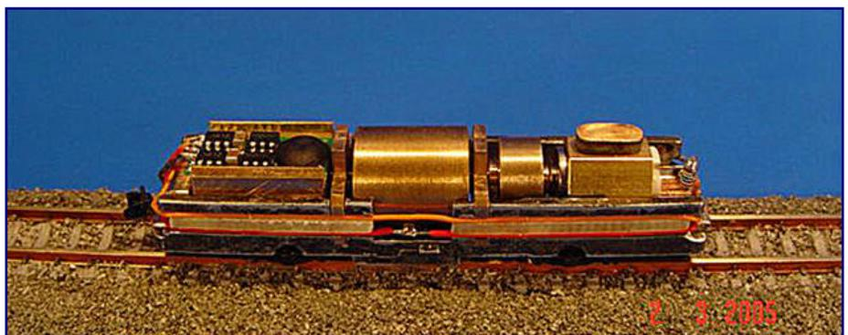
Schienenbusmodell mit Selectrix-Decoder und Fliehkraftkupplung. Foto: Hilmar Weber
