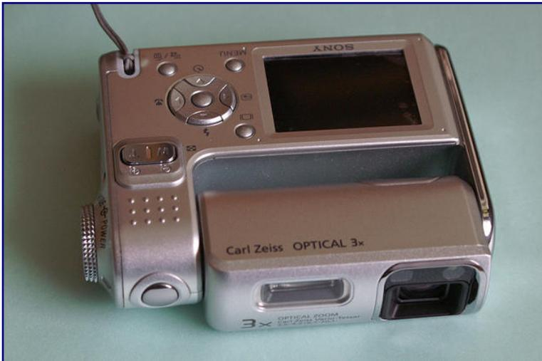
Die Sony DSC-F88 bot eine für die Modellbahnfotografie in der Spurweite Z hervorragende Eigenschaft: Ihr Objektiv lässt sich so drehen, dass die Kamera flach auf der Modellbahnanlage liegen kann. Zusammen mit einem Minimalabstand von 1 cm zum Objekt ließen sich so eindrucksvolle Fotos von Figurengruppen anfertigen.
