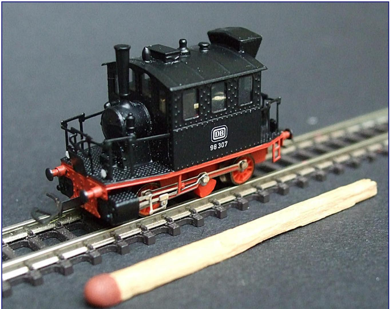
Wie von Z-Modellbau gewohnt, weist auch der „Glaskasten“ 98 307 mit Blindwelle viele, feine Details auf. Dazu gehören auch die Noetenreihen am Führerhaus und an der Pufferbohle oder die geriffelten Trittplächen auf dem Vorbau und den Dampfzylindern. Die Z-Modellbau-Systemkupplung ist optisch unauffällig, aber gleichzeitig voll kompatibel zu Märklins Kupplungen. Foto: Z-Modellbau
