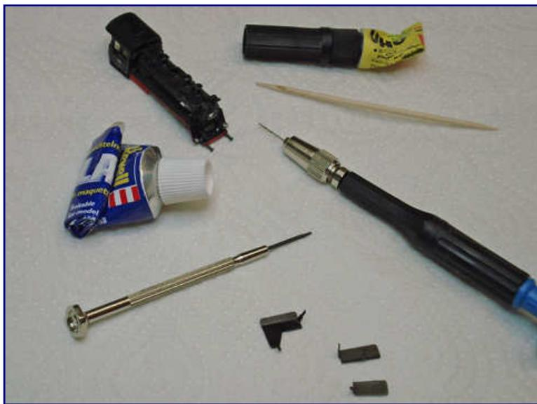
Der Umbau der Windleitbleche auf die Bauart Witte erfordert viel Geduld und Aufwand: Die Aufnahmen der Märklin-Ersatzteile müssen für dieses Modell geändert werden, durch Fräsen muss eine Haltefläche am Gehäuse geschaffen werden. Zum Schluss erfolgen Spachtelarbeiten.
