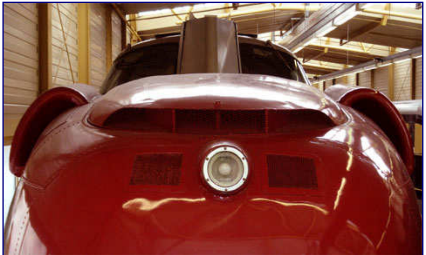
Für den hohen Frischluftbedarf der Gasturbinentriebköpfe musste sich das Gesicht der Baureihe 601 kräftig wandeln. Mit den großen, seitlichen „Ohren“ und der größeren Auspufföffnung verloren die Triebköpfe leider auch ihre ursprüngliche Eleganz. Bildnachweis: DB Museum Nürnberg.
