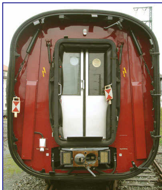
Die Wagenübergänge trugen zwei Faltenbälge zur bestmöglichen Schallisolierung. Bei diesem einzelnen Wagen lässt sich das gut beobachten.
