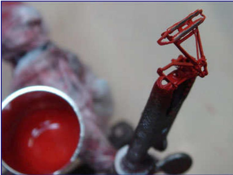
Die Einholmstromabnehmer waren beim Vorbild wegen der Paradenfunktion in RAL 3000 feuerrot lackiert. Dieses auffallende Merkmal sollte auch das Modell aufweisen. Das Schleifstück wird während des Lackierens abgeklebt.
