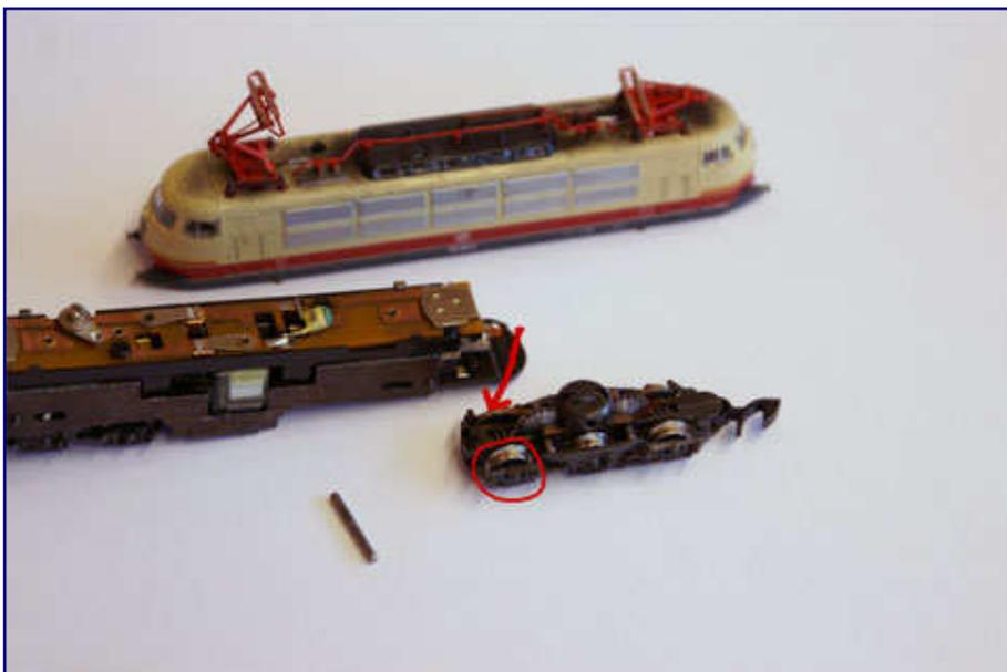
An der teilzerlegten Lok sind einige Modifikationen erkennbar: Auf der hinteren Achse wurde ein Jörgert-Haftreifen aufgezogen (siehe Pfeil; ein weiterer befindet sich auf der gegenüberliegenden Seite an der Innenachse des zweiten Drehgestells). Die Radseitenflächen wurden für eine stimmige Optik schwarz lackiert (siehe Kreis).
