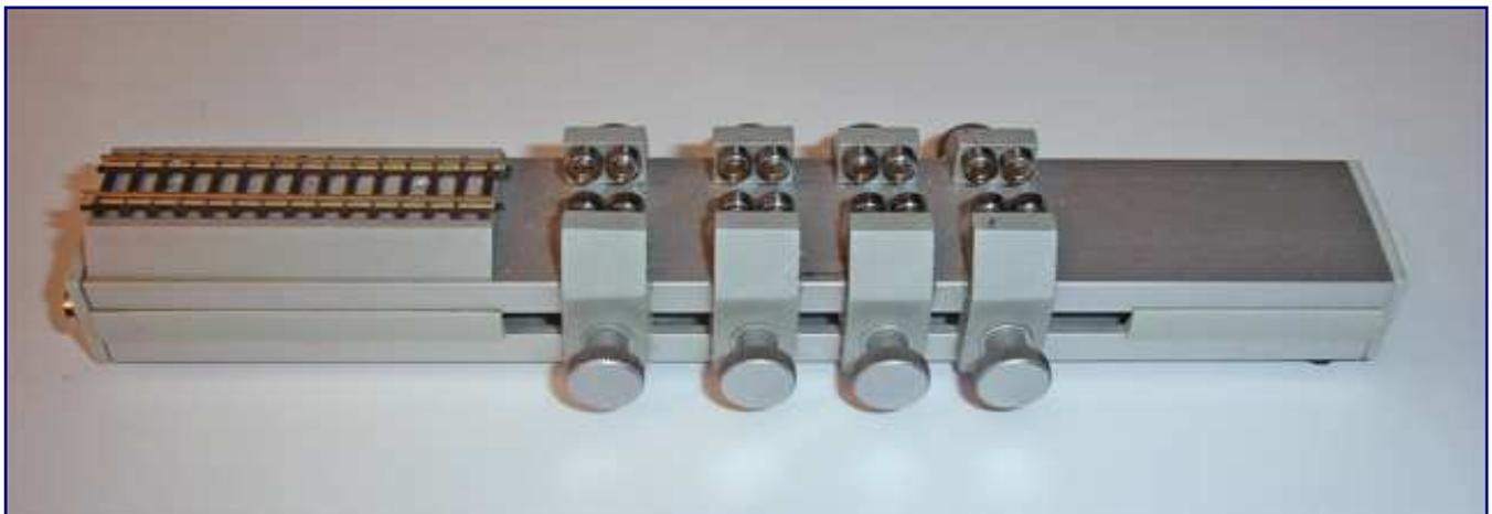
So sieht er aus, der Prüfstand „Spur Z/4“ von SMT. Das abgefallene Schild, das auf den Hersteller hinweist, soll hier nicht täuschen. Alles in allem handelt es sich um präzise gefertigtes Werkzeug, das auch optisch rundum harmonisch durchgestaltet wurde. Foto: Michael Etz
