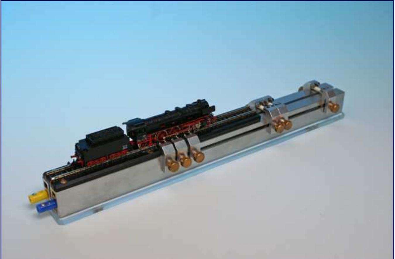
Der Rollenprüfstand von Rolf Palhegy, hier bis auf das aufgestellte Lokmodell im Lieferzustand gezeigt, besticht vor allem durch die raffinierte Idee, die hintere Tenderauflage elektrisch anzuschließen. Damit wird dieses Gerät zum nützlichen Werkzeug für Digitalbahner (als Programmiergleis) und Liebhaber gesuperter Dampfloks, die auch über Tenderstromaufnahme verfügen.
