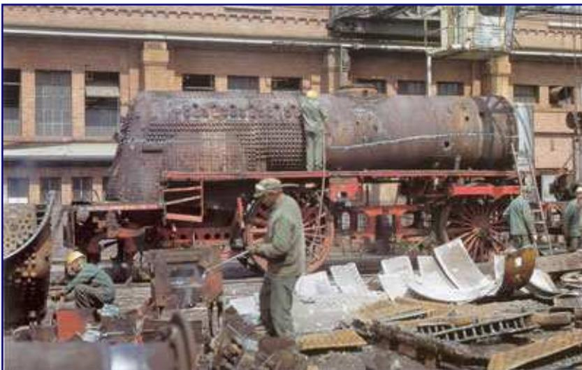
Anfang Juli 1975 ist die Zerlegung von 012 058-4 im AW Braunschweig schon sehr weit vorangeschritten. Sie besaß wie die BR 042 einen vollständig geschweißten Neubaukessel. Gut zu erkennen ist anhand der Stehbolzen das Ausmaß der großen Verbrennungskammer, die mehr feuerberührte Heizfläche zu Lasten der Strahlungsheizfläche schuf. Sie reicht bis an den vorderen Rand der dritten Kuppelachse. Foto: Udo Paulitz
