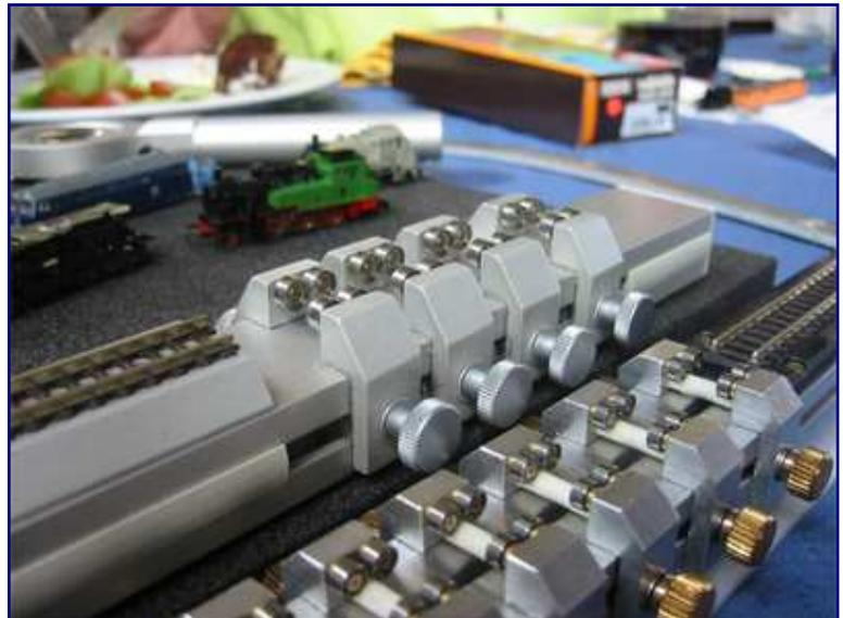
Der direkte Vergleich zeigt die konstruktiven Unterschiede des Klassikers von SMT (oben) und des Prüfstands von Rolf Palhegy, bei dem die Rollenböcke schmaler und beide Hälften durch eine Achse verbunden sind.
