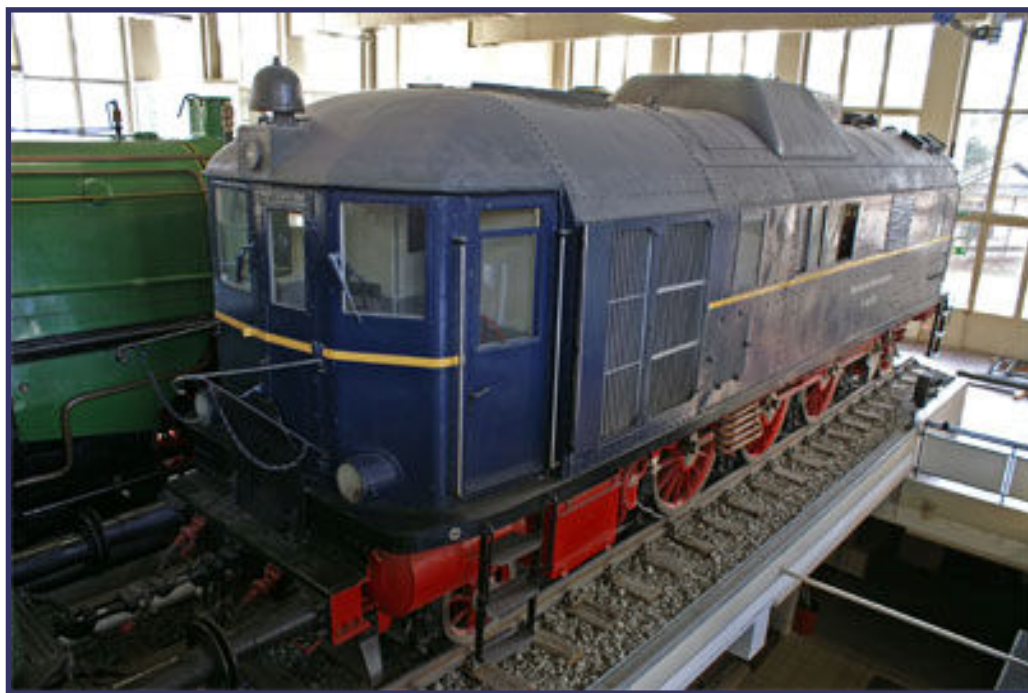
Der Durchbruch im Großdiesellokbau kam mit der dieseldieselhydraulischen V140. Die 1.400-PS-Maschine wurde auf Befehl der Alliierten nach dem 2. Weltkrieg wieder aufgebaut. Sie blieb im Deutschen Museum München erhalten. Bildnachweis / Quelle: Deutsches Museum, München.
