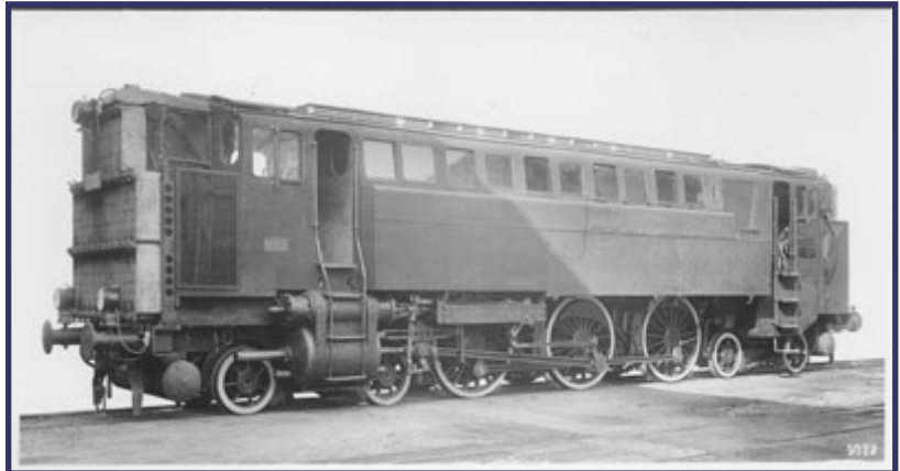
Die Druckluft-Diesellok der Baureihe V32 ist Märklin-Freunden bestens bekannt: Das eisenbahnhistorische Kuriosum gab es als Modell für Spur H0 und Z. Die Lok hatte das Fahrwerk einer Baureihe 78. Foto: DB Museum Nürnberg
