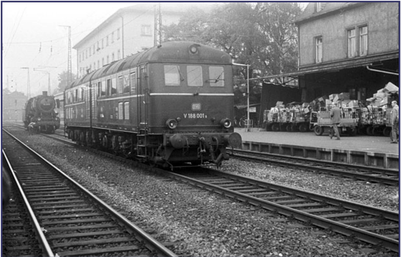
Nur drei Loks der späteren Baureihe 288 (V188) wurden für die Deutsche Wehrmacht gebaut. Nach dem Krieg begann die zivile Karriere der dieselektrischen Maschinen bei der Deutschen Bundesbahn. Hier ist V188 001 a/b in Bamberg Hbf zu sehen. Foto: Walter Patzke, Sammlung Petkelis
