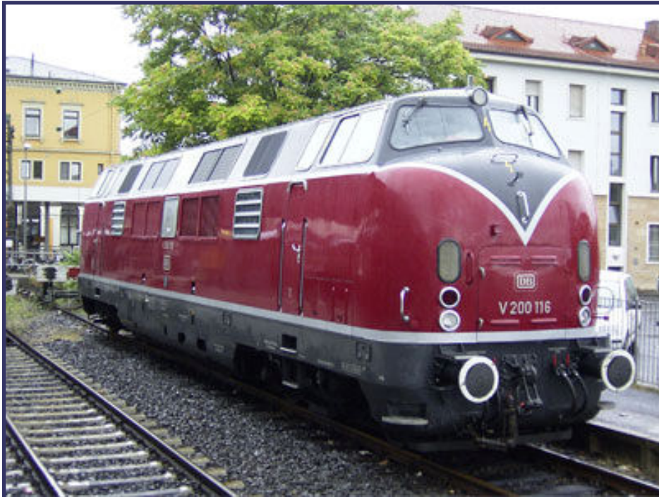
V200 116 repräsentiert die zweite, verstärkte Bauart der legendären V200. Mit 2.700 PS Leistung kam sie später vor allem im Güterverkehr zum Einsatz. Foto: Jörg Neidhöfer
